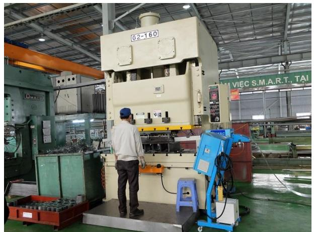
最近導入されたプレス機。電磁材料の型抜き等に使用されている。
