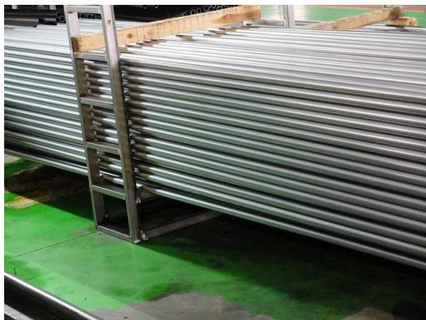
出荷を待つ溶接パイプ。このパイプは電気掃除機の吸引パイプとして使用される。
