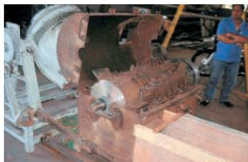
ココ椰子の殻の繊維分離試作機(フィリピン・金属工業開発センター)
